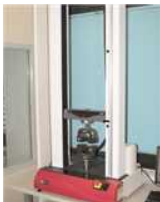
Il microdurometro Shimadzu e la macchina di prova Instron, presso il nostro Centro Bioricerche Marco Pozzi, utilizzate nella verifica delle caratteristiche meccaniche dei fili.
